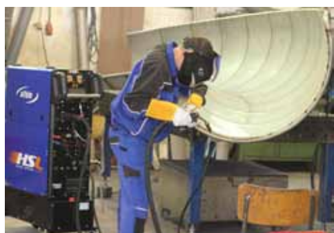
Rozteč 2mm svislá poloha / drát Ø 1mm
