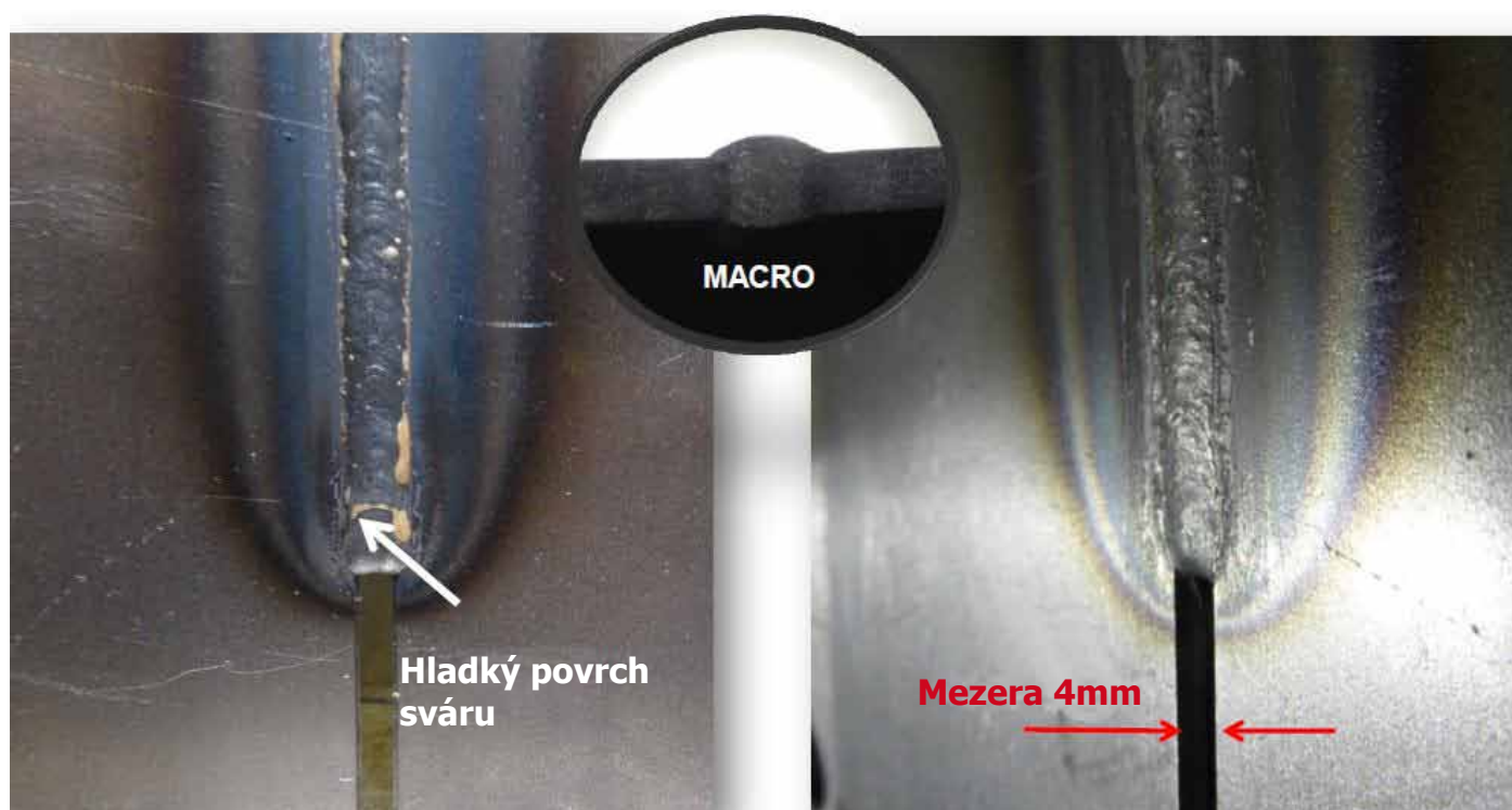
Rozteč 2mm svislá poloha / drát Ø 1mm
