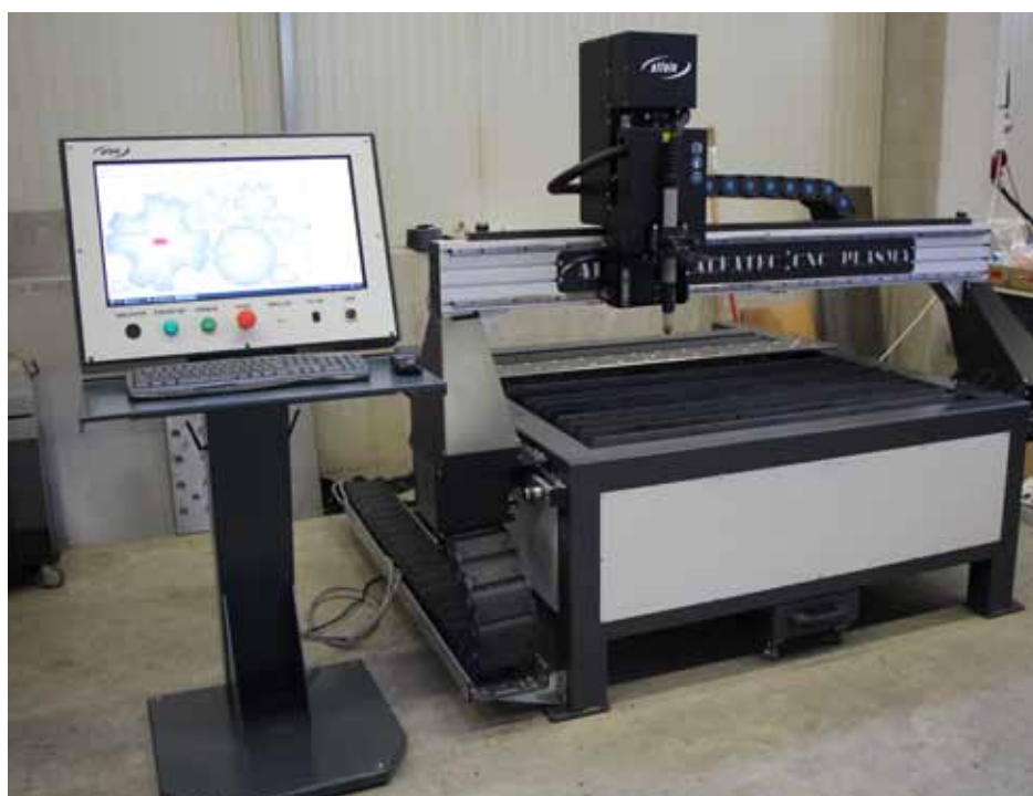
CNC17 ALFATEC CNC kompaktní řezná plocha 1,25x1,25 m Vanový stůl s centrálním způsobem odsávání.
